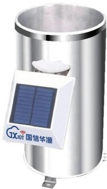
简易雨量报警站是一种集降雨实时监测、信息显示和多时段雨量声光报警功能的雨量监测报警设备，具有多时段雨量统计算法，支持不同级别的声光报警。简易雨量报警器由雨量传感器和入户报警器组成。雨量传感器可以实时监测降雨，通过无线组网向入户报警器发送雨量数据和报警信号。入户报警器安装在居民家中，支持“一处监测、多户报警”，即一个雨量传感器可同时向支持 LoRa-MESH 组网的所有入户报警器发送降雨和报警信号。
