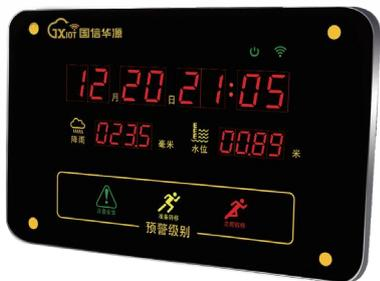
入户报警器具备 4G 公网通信和 LoRaMesh 自组网通信能力，可接收雨量站传来的实时雨量、水位站传来的实时水位和其它预警信息进行显示和播报。同时可通过公网接收县、乡级发布的预警信息。入户报警器也支持 UHF 通信，可接收 UHF 语音播报。紧急情况下，无需村委工作人员上门通知，入户报警器可直接向村民发布报警信息，以增强预警时效，有利于快速组织居民撤离。
