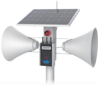
一体化预警广播具备 4G 远程通信和 LoRa-MESH 本地组网功能，实现接收多种信号发布预警信息的设备，支持远程控制播报、本地控制播报和自组网报警三种控制方式。支持的预警信息来源有 11 种途径，分别是 MP3、FM、LIN、UHF、MIC、短信播报警报、平台播报警报、APP 播报警报、电话预警、播放预警录音、一键报警。一般安装在危险区或预警区域的中心位置，采用太阳能供电。
